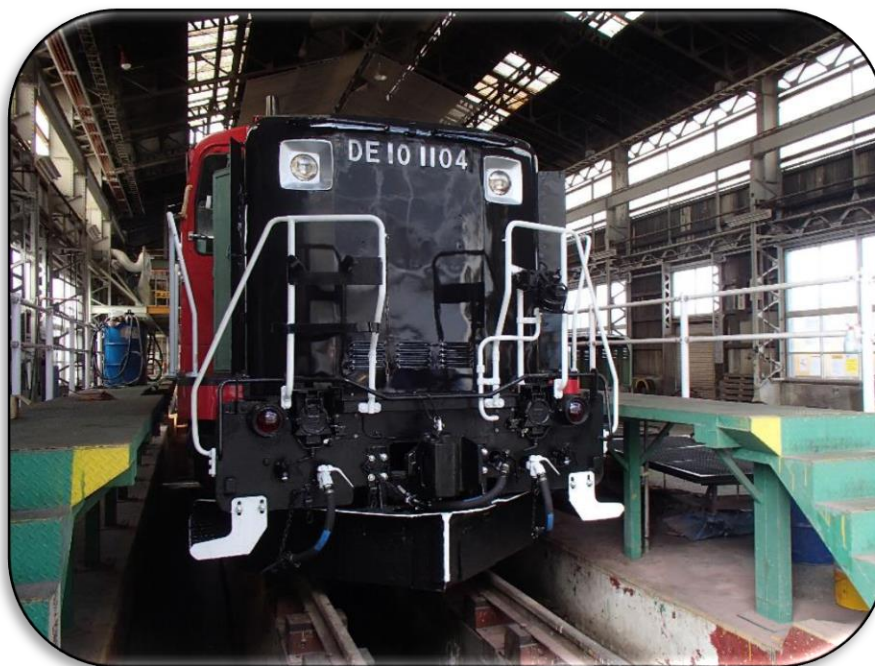
【全般検査中のDE10型機関車】
